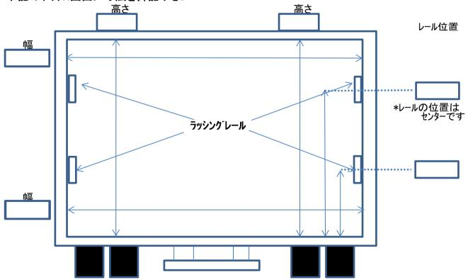
H(高さ寸法)は、フロアー上面から天井内板まで、W(幅寸法)は、左右の内板から内板までの寸法をご記入下さい。
